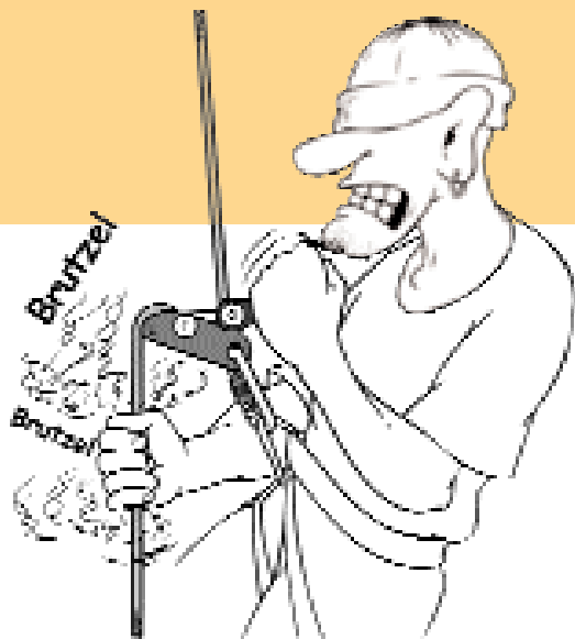
Abb. 1: So passiert ein Ablassunfall mit dem GriGri
