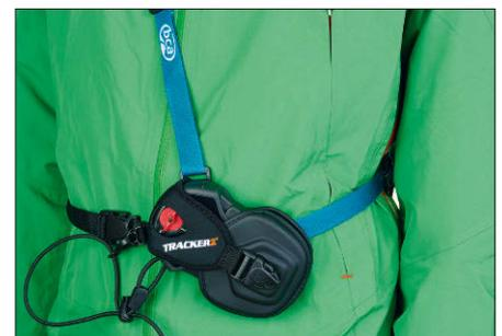
**Top:** Das Holster zeigt auf einen Blick den Ein-/Aus-Drehschalters und lässt sich schnell öffnen. Das Gerät ist beim Rausnehmen mit der Handschlaufe abclippbar am Bauchriemen gesichert (*BCA Tracker 2*).
