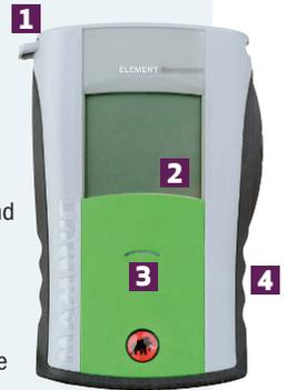
Anzeigefunktionen an (meist mit Selbsttest) und im normalen Sendemodus Taktungsdioden oder Pfeil und evtl. den Batteriestand (*Pieps*, 3+). Bei *Mammut* und *BCA* lässt sich nur an der Schalterstellung erkennen, ob das Gerät an ist, beim *Axis* im Tageslicht praktisch gar nicht (Diode schwach).
